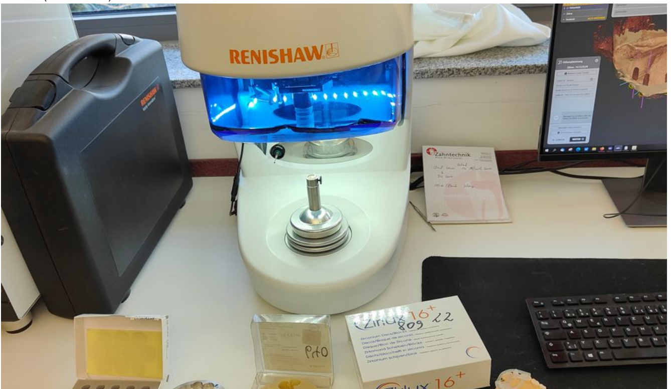
« Zurück Optischer und taktiler Dentalscanner, der die Position und Ausrichtung des Gebissmodells und der Implantate erfasst (Bild 6 von 7) » Vorwärts
